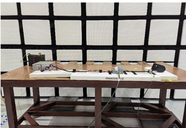
检测项目：大电流注入 检测能力：1~400MHz 检测标准：GB/T 33014.4
