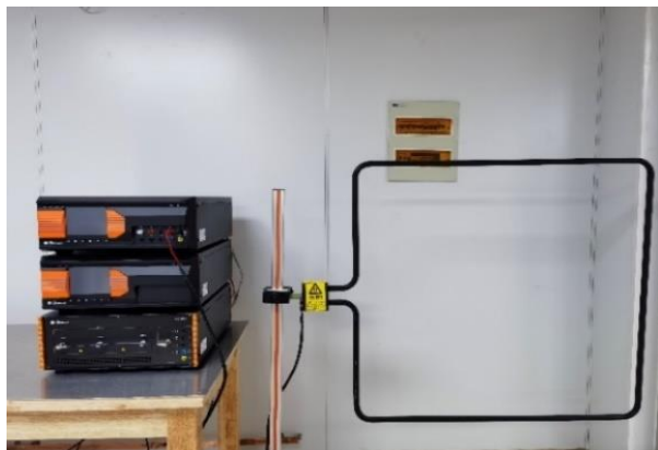
检测项目：阻尼振荡磁场抗扰度 检测能力：0~100A/m 检测标准：GB/T 17626.10
