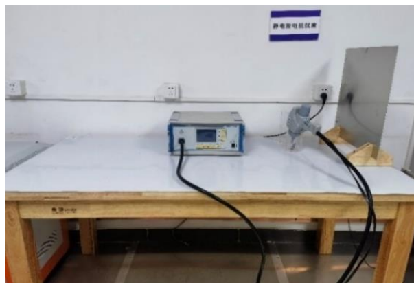
检测项目：静电放电抗扰度 检测能力： \pm 0.2 \sim 20 kV 检测标准：GB/T 17626.2
