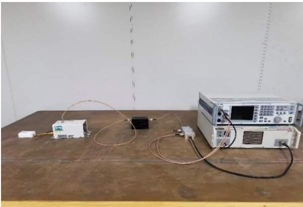
检测项目：射频场感应的传导骚扰抗扰度 检测能力：150kHz~230MHz，1~10V 检测标准：GB/T 17626.6
