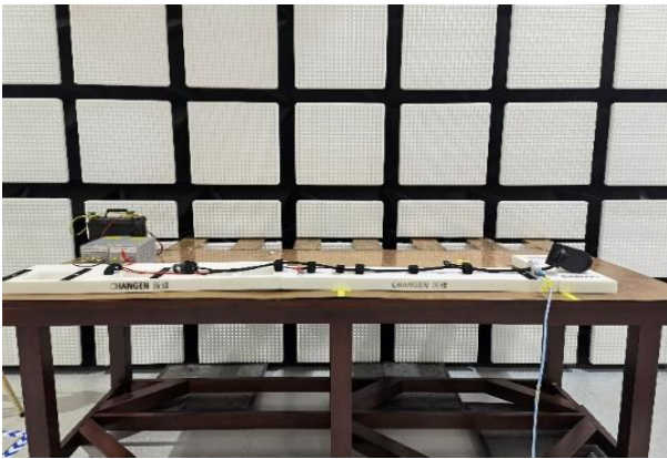
检测项目：传导骚扰电流 检测能力：150kHz~245MHz 检测标准：GB/T 18655
