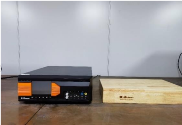
检测项目：电快速瞬变脉冲群抗扰度 检测能力：±0.2~8kV，单相、三相、直流 检测标准：GB/T 17626.4
