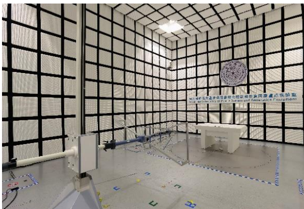
检测项目：电磁场辐射骚扰/辐射杂散 检测能力：9kHz~40GHz 检测标准：GB/T 9254.1, GB 4824, GB 4343.1, YY 9706.102, YD/T 1483 等
