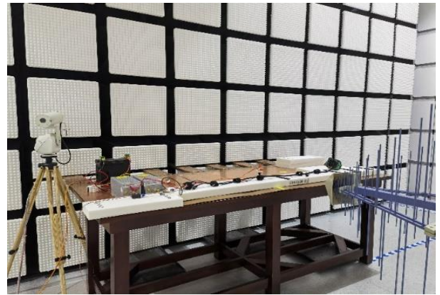
检测项目：辐射抗扰度 检测能力：80MHz~6GHz，最大 200V/m 检测标准：GB/T 33014.2
