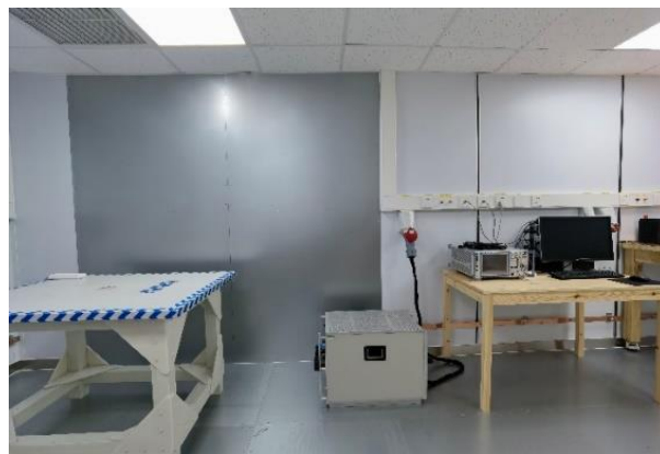
检测项目：电源端子传导骚扰 检测能力：9kHz~30MHz 检测标准：GB/T 9254.1, GB 4824, GB 4343.1, YY 9706.102 等
