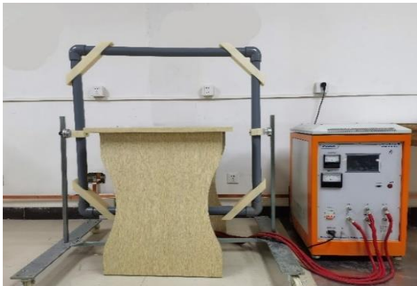
检测项目：工频磁场抗扰度 检测能力：0~1200A/m 检测标准：GB/T 17626.8
