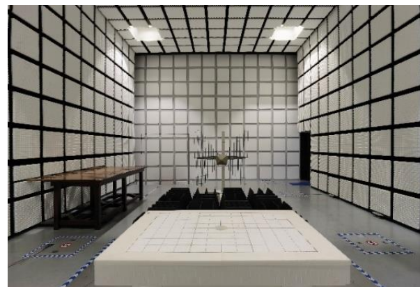
检测项目：射频电磁场辐射抗扰度/音频突破 检测能力：80MHz~6GHz, 1~30V/m 检测标准：GB/T 17626.3, YD/T 2583.6 等
