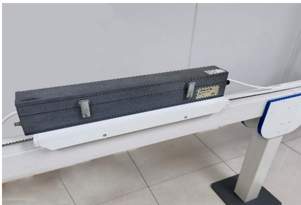
检测项目：骚扰功率 检测能力：30MHz~1GHz 检测标准：GB 4343.1
