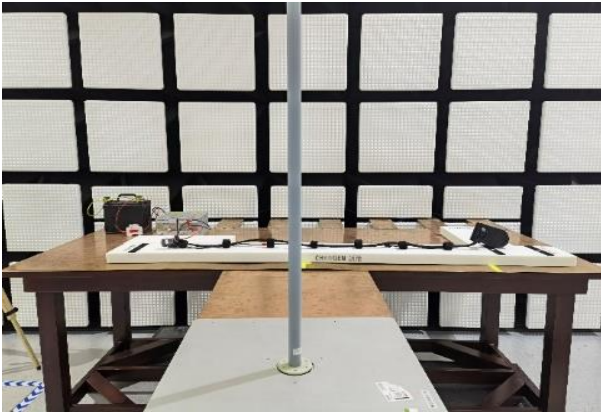
检测项目：辐射骚扰 检测能力：150kHz~18GHz 检测标准：GB/T 18655
