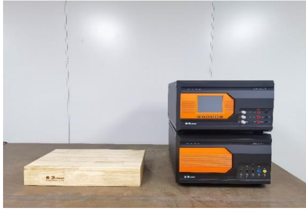
检测项目：浪涌（冲击）抗扰度 检测能力：±0.3~6kV，单相、三相、直流 检测标准：GB/T 17626.5
