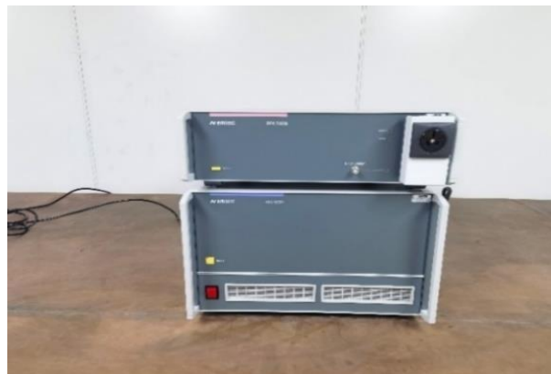
检测项目：谐波电流/电压波动和闪烁 检测能力：小于 16A 设备 检测标准：GB 17625.1, GB/T 17625.2
